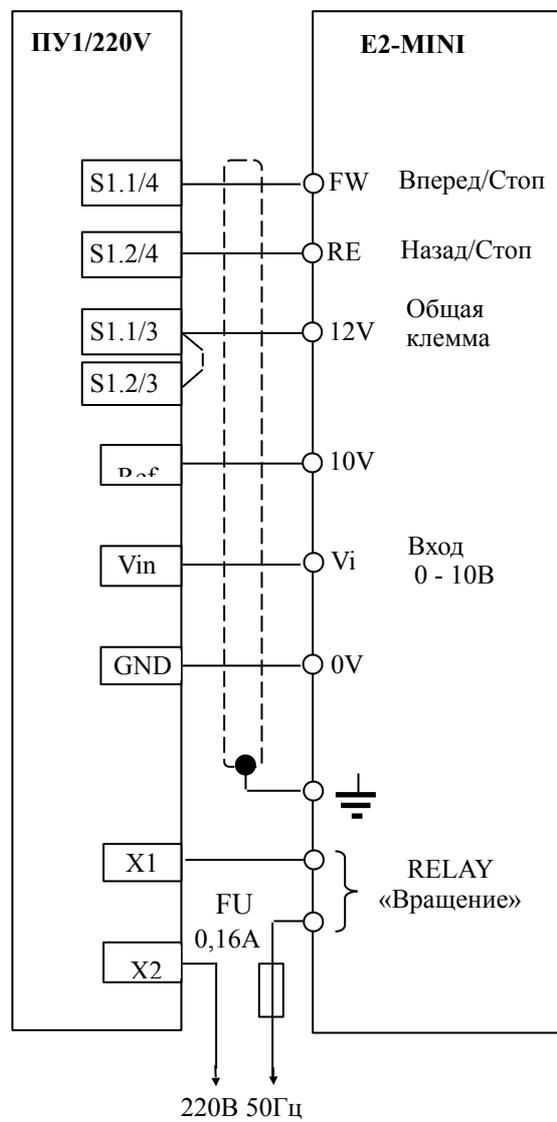
Рис. 3. Схема подключения пульта управления ПУ1/220V (версия 1.1)
