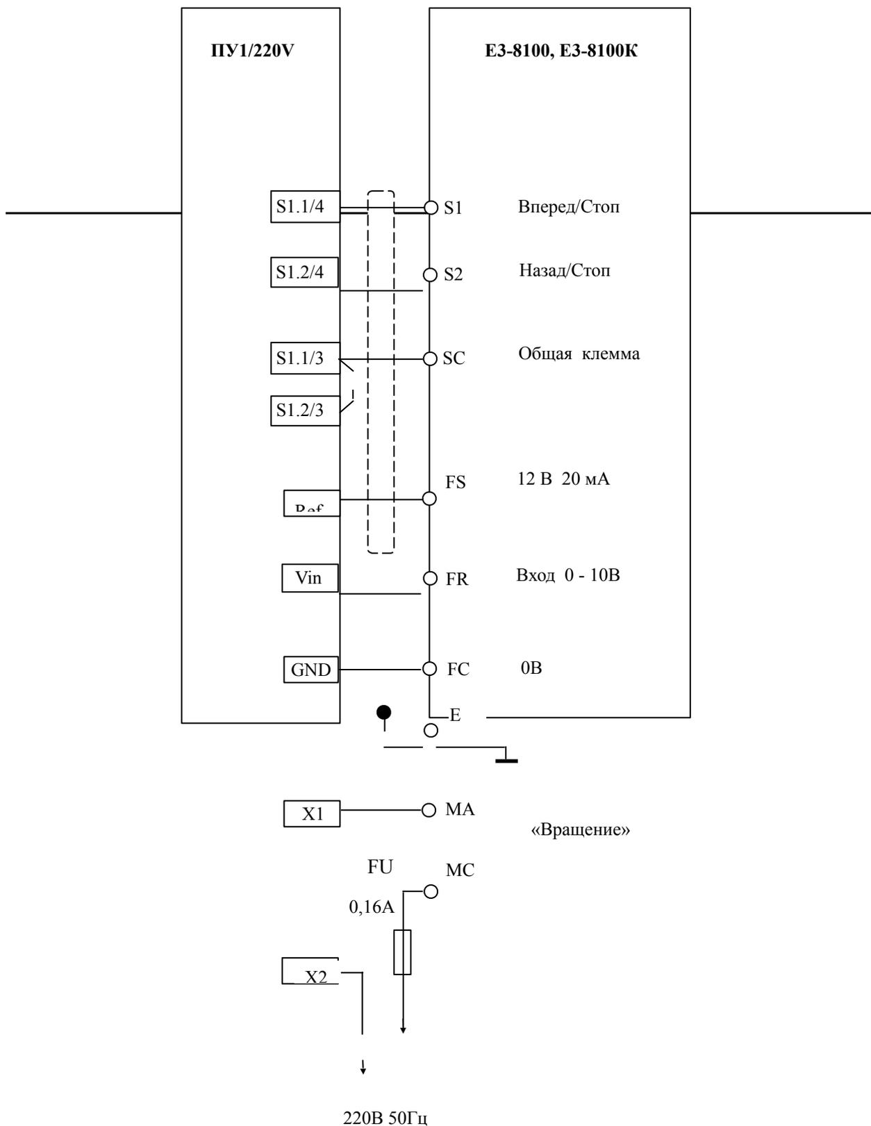
Рис. 9 Схема подключения пульта управления ПУ1/220V (версия 1.1) к E3-8100, E3-8100K .
