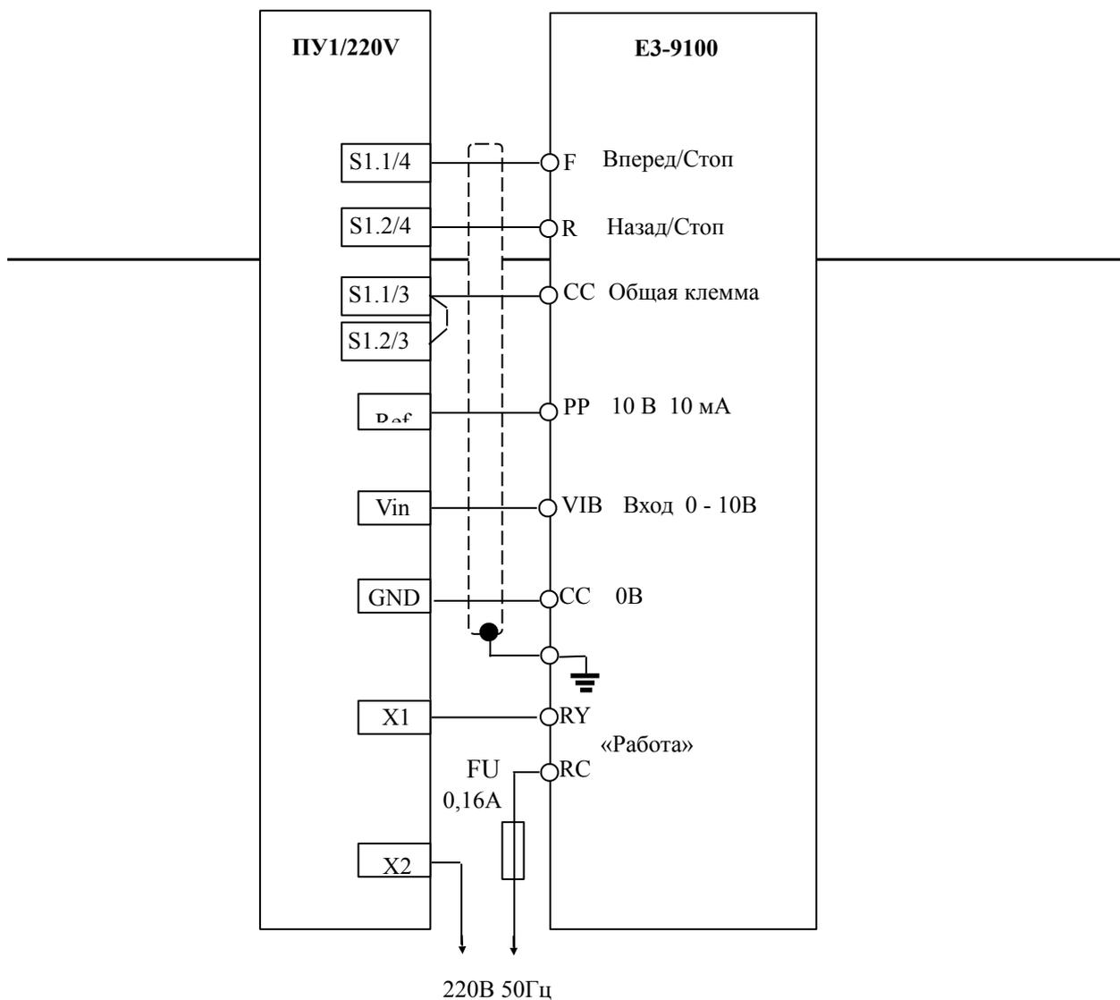
Рис. 8 Схема подключения пульта управления ПУ1/220V (версия 1.1) к ЕЗ-9100.
