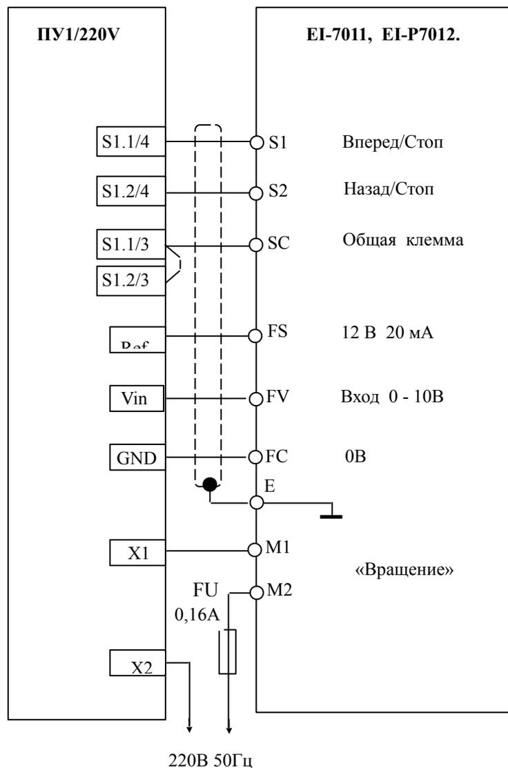
Рис. 6 Схема подключения пульта управления ПУ1/220V (версия 1.1) к EI-7011, EI-P7012.
