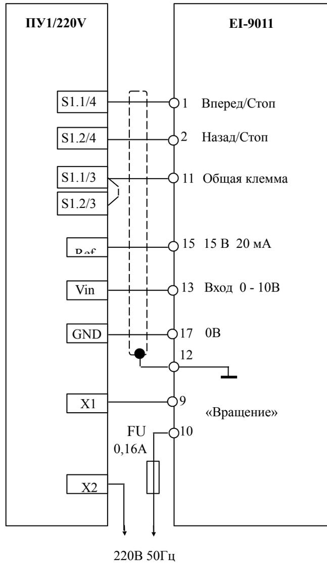
Рис. 7 Схема подключения пульта управления ПУ1/220V (версия 1.1) к EI-9011.
